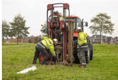
جرار مزود بألة حفر صغيرة لإجراء المسح الزلزالي بحفر التفجير
