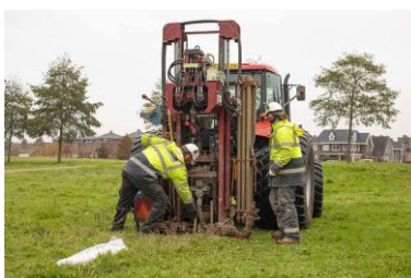
Tractor met boor voor shotgatseismiek
