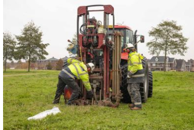
Kuyu içi patlatma yöntemi için matkaplı traktör
